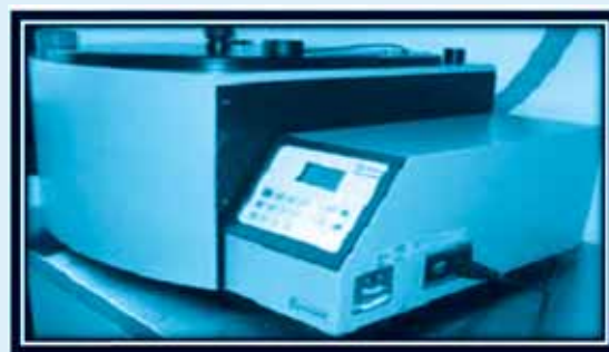
شکل ۲ نمایش از دستگاه ولتامتری برای اندازه‌گیری جیوه
